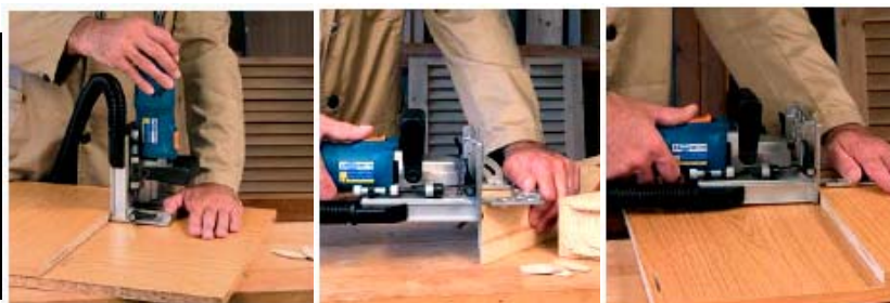
Соединение по центру панели Соединение "в ус" для рам Угловое соединение
