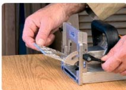
Угол и высота регулируются по встроенным шкалам
